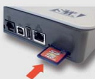
Speichererweiterung und Datenübertragung zum PC mit austauschbarer SD-Karte
